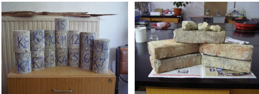
Slika 11. Uzorci betona, opeke i maltera za laboratorijsko ispitivanje
